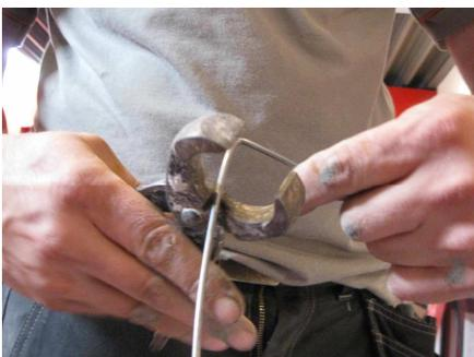
Hafnerdraht zu einer Klammer biegen.
