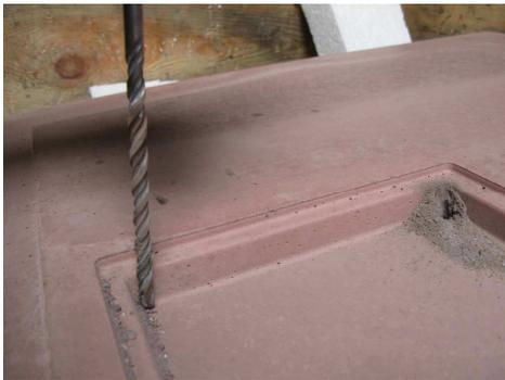
Um an den Ecken einen sauberen Ausbruch zu schaffen, hier mit einem Steinbohrer durchbohren.
